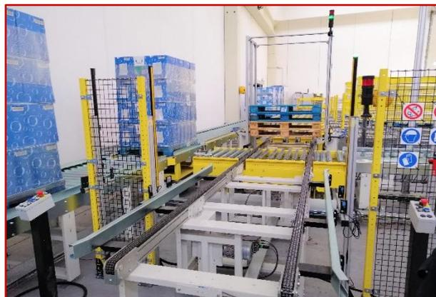
L'entrata e l'uscita delle merci dal magazzino avvengono al livello 0, attraverso un sistema di handling formato da trasportatori automatizzati di vario tipo. I pallet in ingresso (Europallet o Düsseldorf accoppiati) vengono posizionati attraverso un transpallet nella
