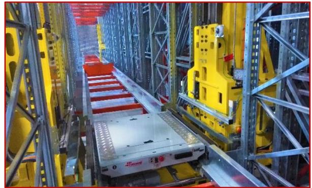
Al momento dell'output, il pallet viene prelevato dal magazzino tramite uno dei sistemi traslo ICRANE/ pallet shuttle ISAT, posizionato nel sistema di handling e, se necessario, svincolato dal pallet di servizio attraverso un depalletizzatore. Il sorter di uscita, realizzato con trasportatori a quattro catene, per gestire anche i pallet Düsseldorf accoppiati e scambi a rulli, smista i pallet su dieci rulliere a gravità con terminale idoneo al prelievo tramite transpallet.
