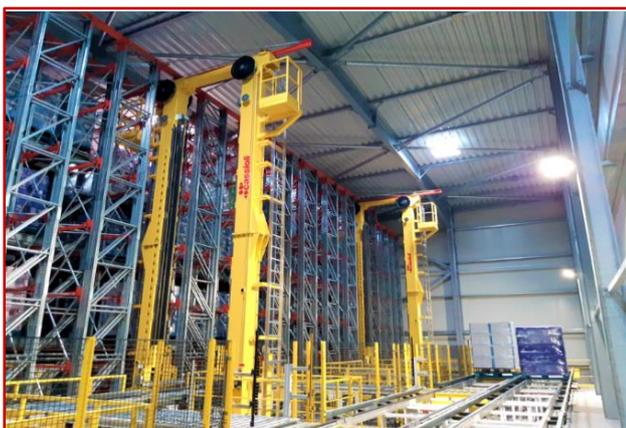
Cassioli ha progettato la realizzazione di un sistema automatico di storage formato da 3 trasloelevatori ICRANE con pallet shuttle ISAT per stoccaggio in multi-profondità.
