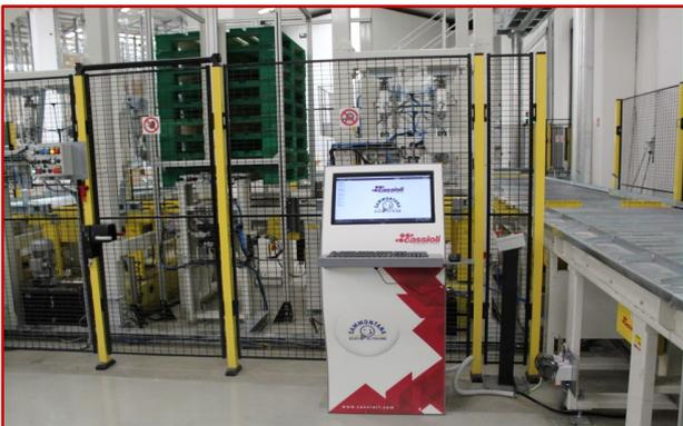
All'interno del nuovo fabbricato, Cassioli ha progettato la realizzazione di un innovativo magazzino automatico formato da 4 trasloelevatori in doppia profondità e di un trasloelevatore ICRANE con shuttle ISAT: quest'ultimo traslo ha permesso di sfruttare al massimo la superficie disponibile grazie allo stoccaggio di pallet in multiprofondità. I pallet in ingresso arrivano in magazzino e, attraverso un sistema di
