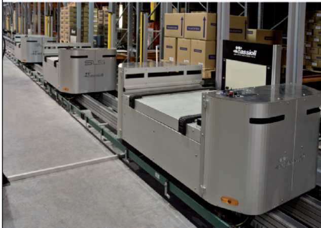
Sistema SLS per movimentazione di pallet di 1.500 Kg alla velocità di 5 m/s.
